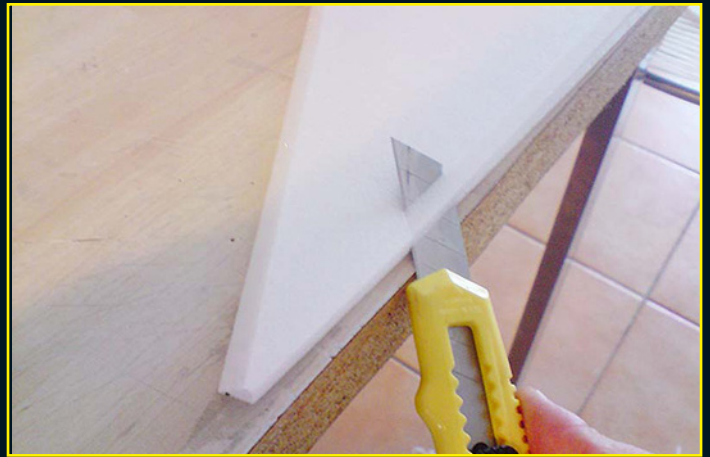
02 - Ebauche des chanfreins au cutter.
